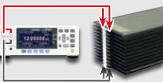
셀 접합부 · 부스바의 저항을 측정함으로써 용접의 품질을 확인할 수 있습니다. 용접이 불량한 경우, 연결부의 저항이 높아져 충전전 시에 큰 열 손실이 발생합니다.
