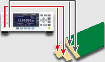
용접부의 저항을 측정함으로써 용접품질를 확인할 수 있습니다. 용접 불량인 경우, 연결부의 저항이 높아져 충방전 시에 열이 발생해 배터리 수명에 영향을 줍니다.
